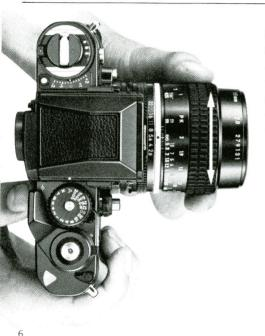
ピント合わせは、ファインダーを覗いて像が鮮明になるまで 距離リングを回します。レンズ単体では無限遠から0.25m(倍 率は1:2)まで、オート接写リングPK-13、あるいはテレコン バーターTC-200または、TC-201Sを併用するとさらに近接し て等倍までの撮影ができます。これらを併用しても、レンズ の自動絞り機構はそのまま使えますので、絞り開放でピント 合わせができます。距離目盛は、メートル目盛(白色)とフィ ート目盛(黄色)が併記され、カメラのフィルム面から被写体 までの距離を示します。
